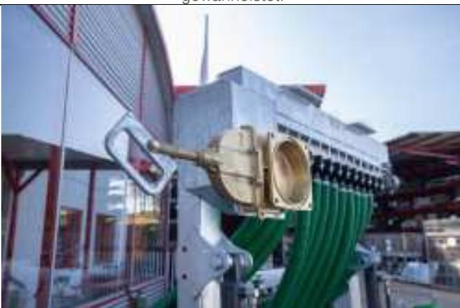
Staukasten für Fremdkörper - mechanische Entleerung
