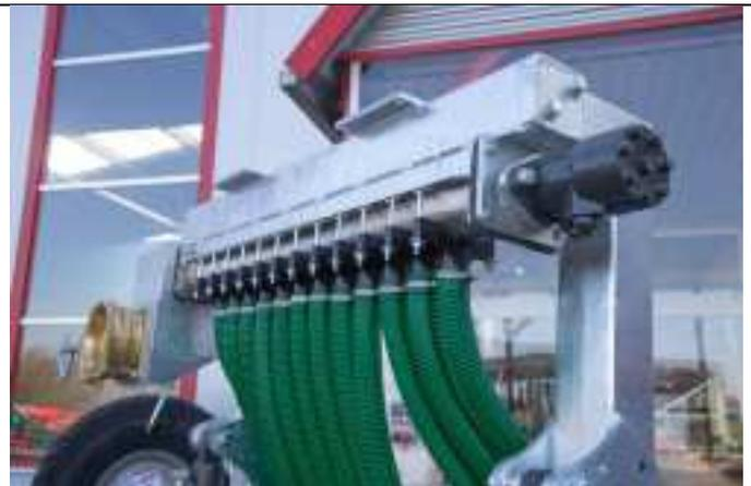
Schneckenverteiler: hydraulischer Antrieb, ca. Ölleistung 20 Liter/min
