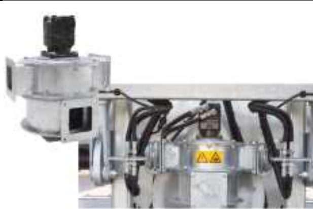
Nur bei extrem hohen Faseranteil erforderlich: Zerkleinerungscutter zum Anbau zentral zwischen Fass und Verteiler (erforderliche Ölleistung 60l). Der Antrieb erfolgt direkt über das Schleppersteuergerät.
