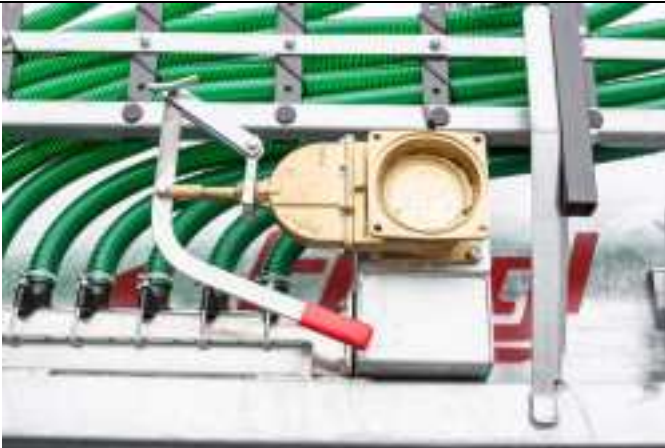
Staukastenöffnung mechanisch oder hydraulisch
